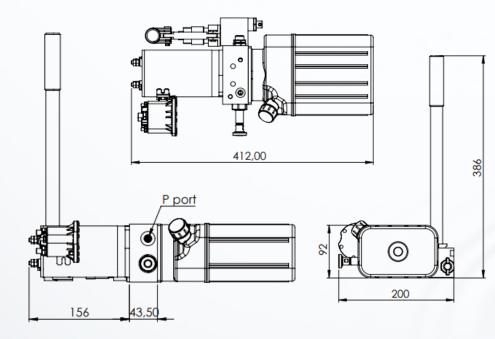
**ELECTRIC MOTOR** Power: 0,8 kW
